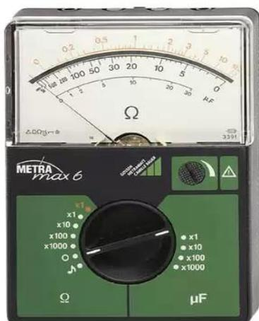
Омметр является прибором непосредственного измерения сопротивления. Его работа основана на измерении тока в цепи исследуемого сопротивления. Так как поданное напряжение и измеряемое сопротивление, постоянные
