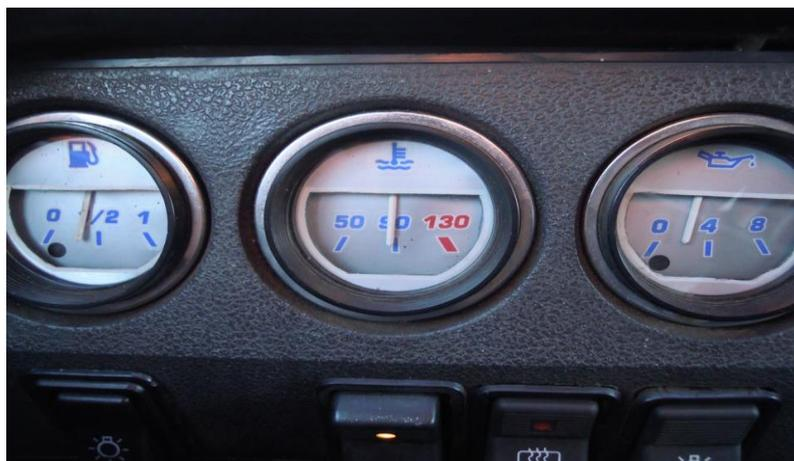
В качестве указателя логометрического манометра применяется магнитоэлектрический прибор, состоящий из двух пластмассовых полукаркасов, на которые намотаны три измерительные индукционные катушки, причем одна катушка расположена под углом  $90^\circ$  к двум другим. Постоянный магнит установлен внутри каркаса на одной оси со стрелкой.
