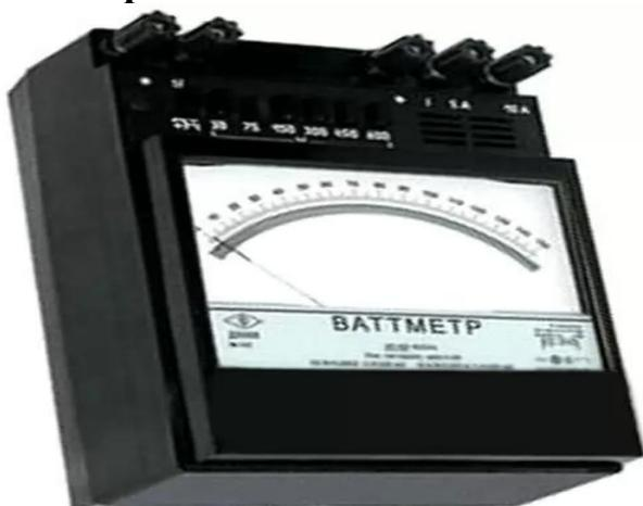
Ваттметр – измерительный прибор, имеющий назначение определять работу совершаемую электрическим током в единицу времени для прохождения
