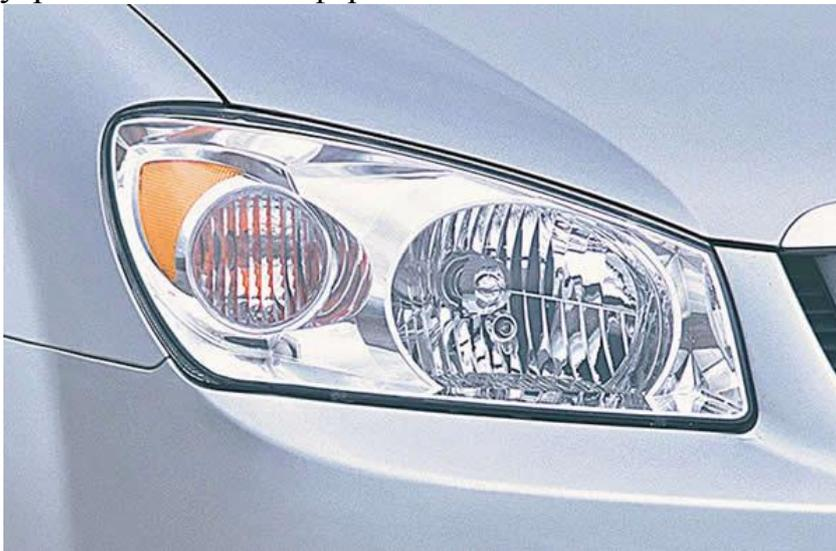
Блок-фара автомобиля включает в себя прямоугольную или овальную фару с лампами основного и габаритного света, сблокированную с фонарем
